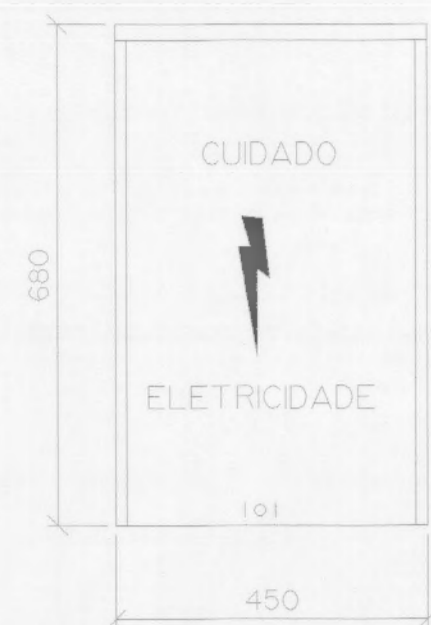
DETALHE 10 CAIXA PARA TRANSFORMADOR DE CORRENTE TIPO TC VER NOTAS 14, 15 E 16 S/ ESCALA
